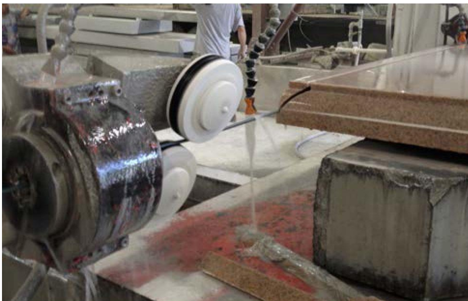
Otočná kladka profilové lanové pily GRANI ROC při práci v USA.
