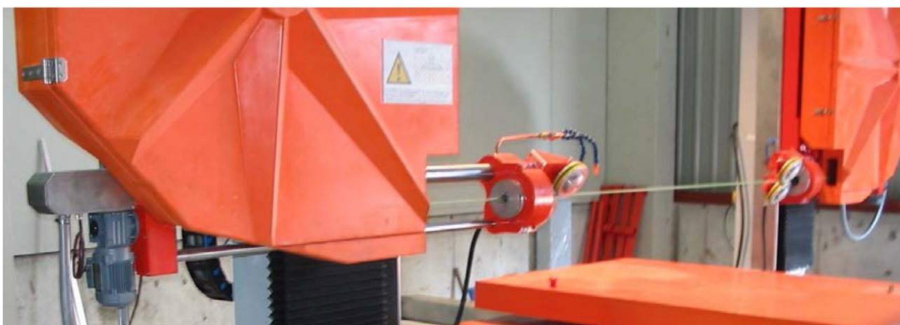
Otočná kladka profilové lanové pily GRANI ROC při práci v USA.
